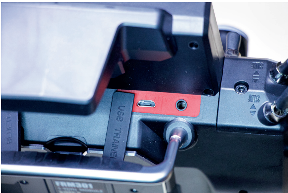
Ein kleines, aber feines Detail. Wird die Gummiabdeckung der Ladebuchse entfernt offenbart sich ein leuchtend roter Hintergrund. So fällt der entfernte Staubschutz schnell ins Auge
